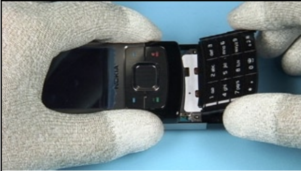
57. Insert the BOTTOM KEYMAT.
